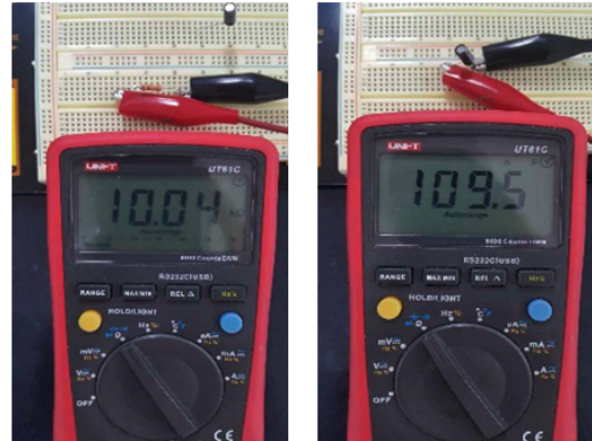
[그림 6] 저항값 및 전기용량 측정
