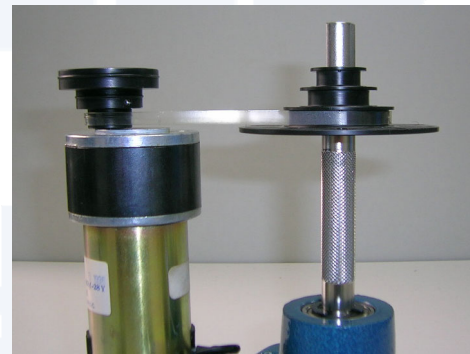
↑ [그림 6] 회전 스탠드의 3중 도르래와 고무 밴드로 연결된 DC 모터.
