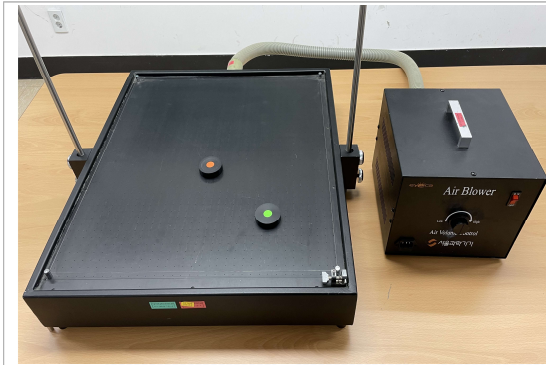
Air Table 과 Air Blower
